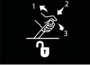
PULL HANDLE UP, PUSH BUTTON IN, PUSH HANDLE DOWN TO RELEASE PARK BRAKE
