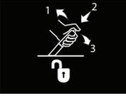
PULL HANDLE UP, PUSH BUTTON IN, PUSH HANDLE DOWN TO RELEASE PARK BRAKE
